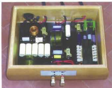
Il complesso crossover è realizzato in box a parte; eccezionale il numero e la qualità dei componenti; c'è un potenziometro di potenza da 10 ohm a filo preposto a regolare "a sella", in modo fine, il livello di un segmento in gamma alta della risposta.
