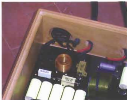
Il complesso crossover è realizzato in box a parte; eccezionale il numero e la qualità dei componenti; c'è un potenziometro di potenza da 10 ohm a filo preposto a regolare "a sella", in modo fine, il livello di un segmento in gamma alta della risposta.
