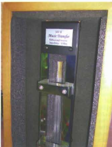
Un particolare posteriore del massiccio mid-tweeter a nastro di speciale produzione Relco Audio.
