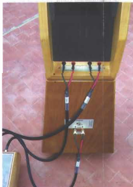
I cavi in uscita per le tre vie del diffusore già forniti e contrassegnati sono di eccezionale qualità.
