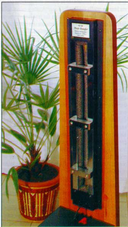
La vista posteriore rivela le dimensioni effettive e la struttura di supporto del trasduttore originale che, con emissione perfettamente dipolare, copre l'ampia banda di frequenze da 500 Hz in su.
