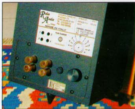
Possibilità di bi-wiring, fusibile ritardato e regolazione (ad escursione molto discreta nell'ampiezza sonora) del livello del mid-tweeter mediante potenziometro.
