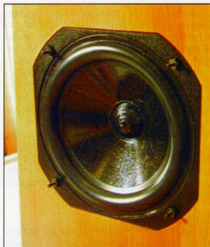
Anche il woofer da 16 cm della Focal è "customizzato" per la Venus. Opera in cassa chiusa ed ha tecnologia di alto livello (membrana in "polikevlar", cestello in magnesio etc.).
