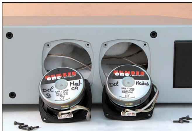
*I due piccoli woofer della serie più sofisticata e tecnologica prodotta dalla Monacor, vengono abbinati al mid-tweeter a nastro Relco Audio per sostenerne le doti nella gamma bassa e medio-bassa. Eccellente la realizzazione del mobile, i dettagli di fissaggio dei componenti ed il cross-over.*
