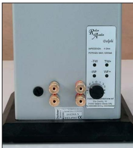
*Fusibile, "morsettoni" atti al bi-wiring e commutatore del livello fine unità a nastro a 9 posizioni sono identificativi delle Delphi, costruite in maniera impeccabile. Da tenere conto che l'impedenza nominale è di 4 ohm. L'efficienza reale in ambiente è media e tale che è meglio scegliere un'amplificazione raffinata, piuttosto che superpotente.*
